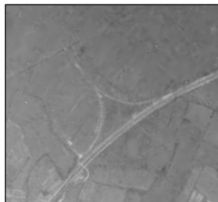
Comme il est possible de l'observer, en comparant la vue aérienne de 1937 à gauche et celle de 1945 à droite, le tiroir de manœuvre a été allongé, à priori par l'OT afin d'accueillir une « gare militaire » permettant le transbordement entre réseaux normal et Decauville.
