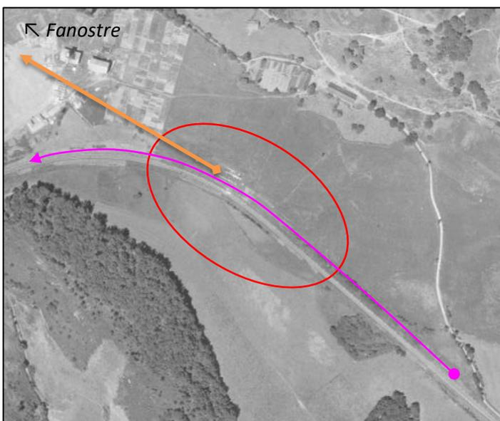
Ci-contre, vue aérienne de 1947 avec les fondations supposées du hangar et de la gare de départ. La flèche orange matérialise approximativement l'orientation du transporteur aérien, et le tracé violet l'EP à deux voies. L'aiguille d'entrée devait se situer à gauche, côté gare de Ydes, avec un accès en rebroussement depuis cette dernière.
