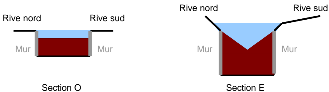
Envasement constaté de la tranchée
