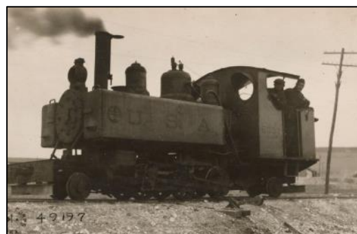
Contrairement au système français qui compte les essieux, le système américain compte toutes les roues.
