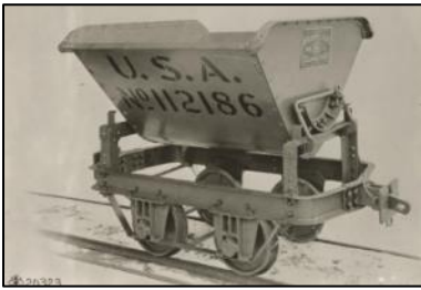
Wagon à benne basculante de 0,75 m 3 fabriqués dans l'Ohio par Kilbourne & Jacobs Co.
