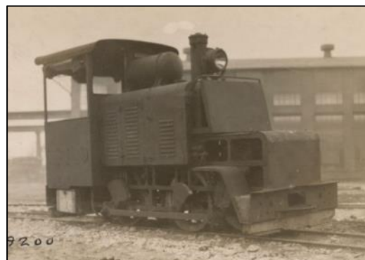
Locotracteur Baldwin à essence de 50 cv construit à Philadelphie.
