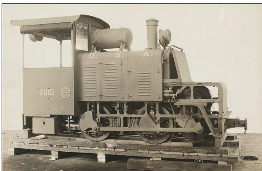
Locotracteur Baldwin à essence de 50 cv construit à Philadelphie.
