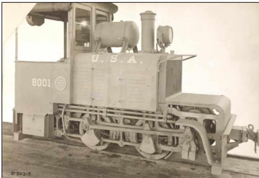
Locotracteur Baldwin à essence de 35 cv construit à Philadelphie.
