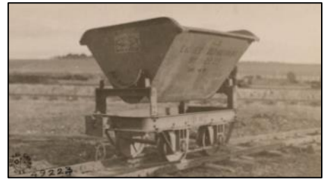
Wagon à benne basculante de 0,75 m 3 fabriqués dans l'Ohio par Kilbourne & Jacobs Co.
