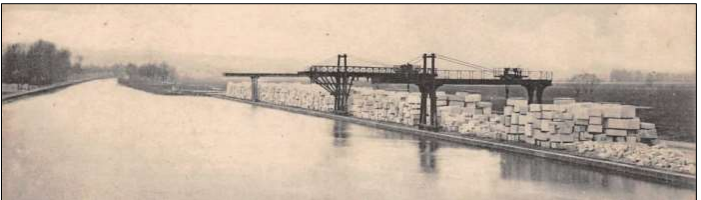
Les 3 grues mobiles de 10 tonnes permettant le chargement des pierres de taille.
