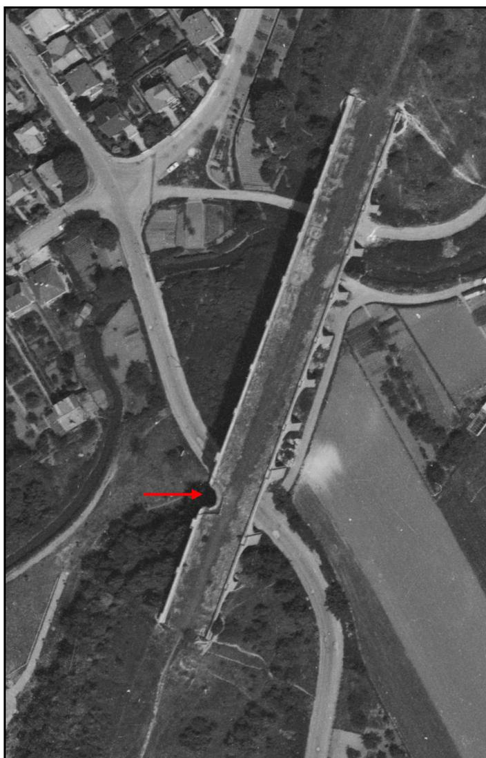
Le viaduc sera rasé fin 1969, début 1970. Il cèdera par la suite sa place à un passage routier souterrain sous un faux remblai contenant une galerie d'isolation acoustique dans laquelle passe la LGV Ouest.
