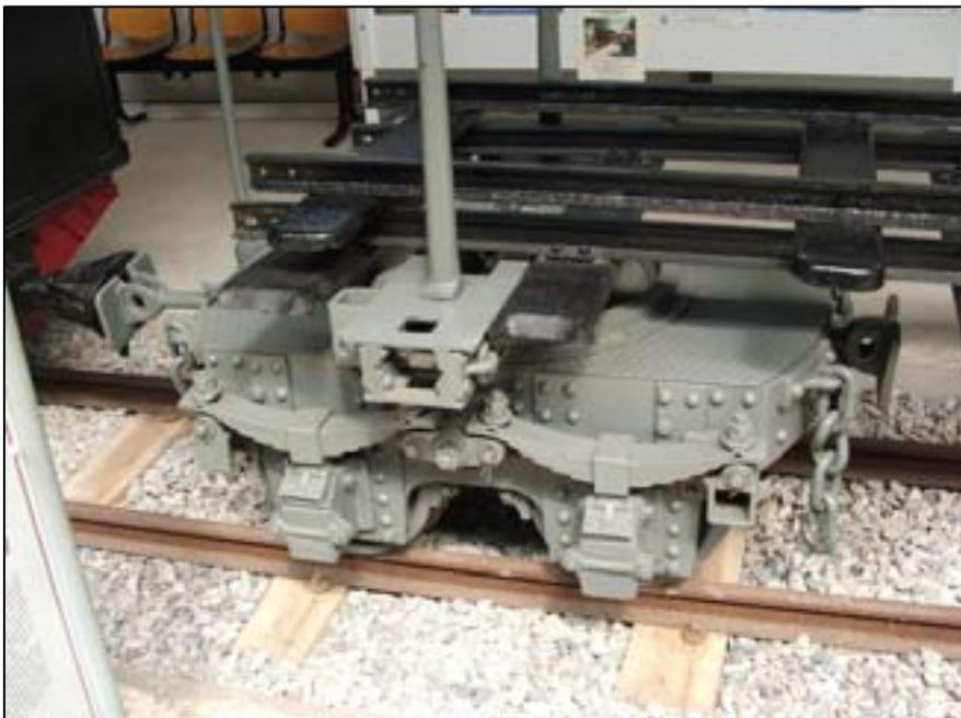
Il s'agit d'un bogie à 2, 3 ou 4 essieux sur ressorts à lames et balanciers, supportant respectivement 5, 9 et 12 tonnes. Il est muni d'un plateau pivotant sur lequel on peut monter une traverse et une barre de liaison permettant de l'accoupler à un autre bogie. Il peut recevoir un frein à volant. Son centre de gravité est situé très bas. Sur les extrémités de la traverse, on peut monter des barres verticales, les ranchers, destinés à maintenir en place les chargements longs.
