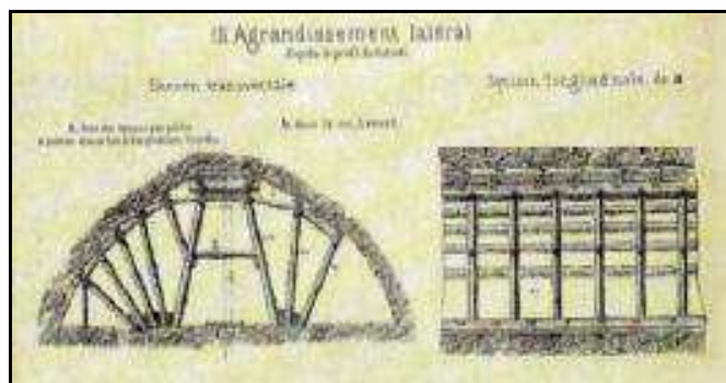
Formes de boisages utilisés pour soutenir la voûte en cours d'ouverture
