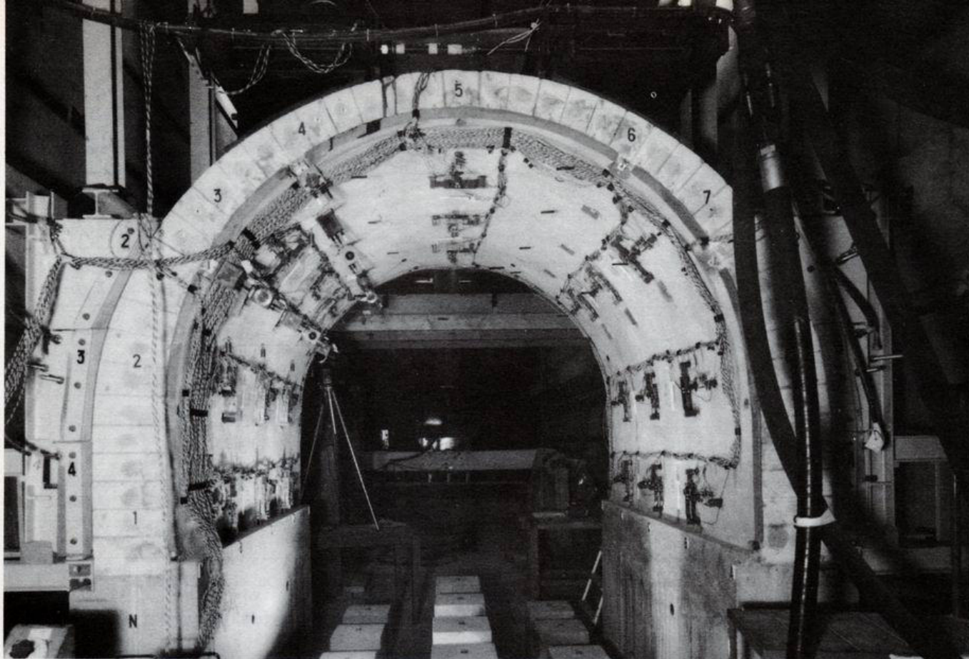
Fig. 5. — Essais de voûtes renforcées par une coque en béton projeté.
