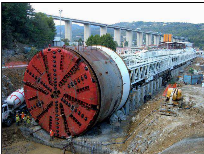
Tunnelier avec sa tête de coupe, son train suiveur et ses vérins géants
