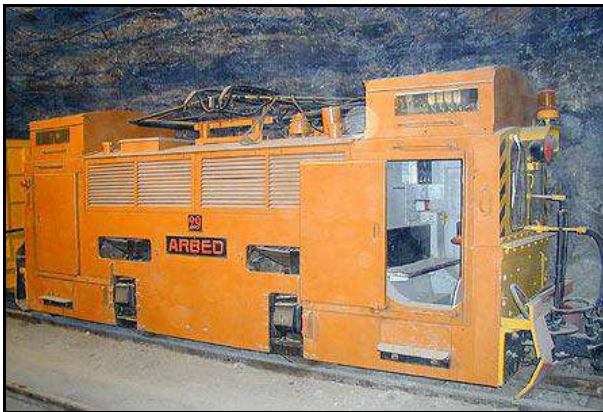
Locomotive et wagon de fort tonnage pour évacuer les déblais
