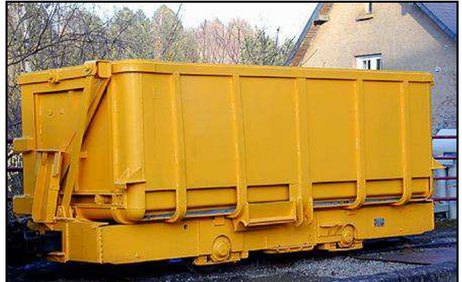
Locomotive et wagon de fort tonnage pour évacuer les déblais
