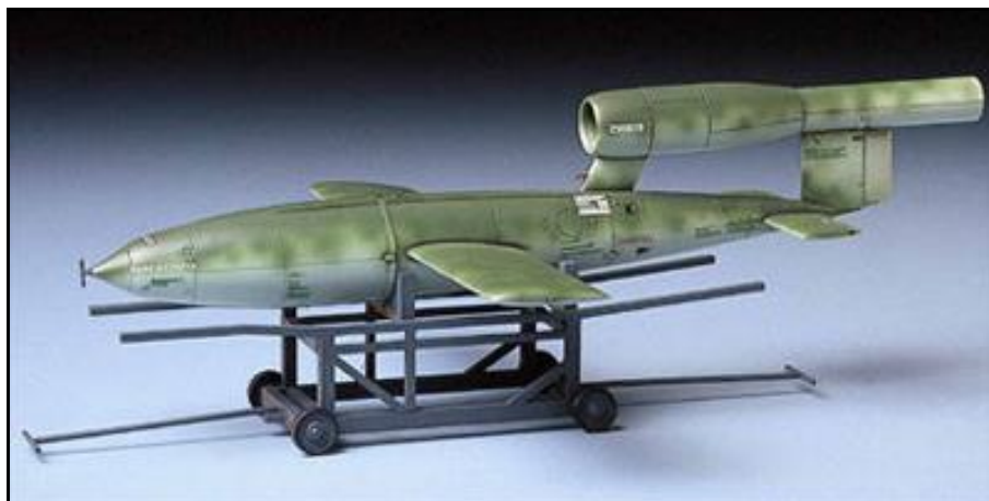
V1 sur son chariot de manutention et mise en place sur rampe de lancement
